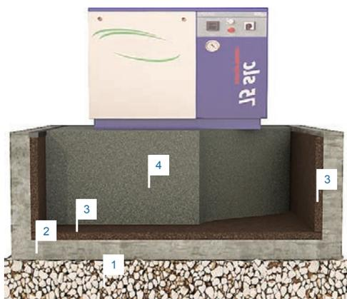
1. Enrocamento 2. Forjado de hormigón 3. Aglomerado de corcho expandido - ICB Alta densidad 4. Muro de Soporte Hormigón Armado
